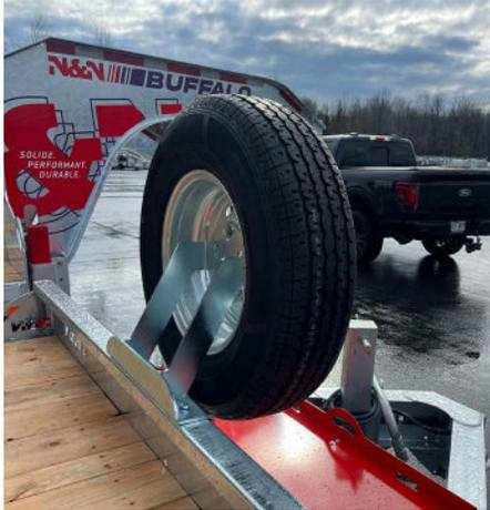
Support de roue de secours (boulonné)
