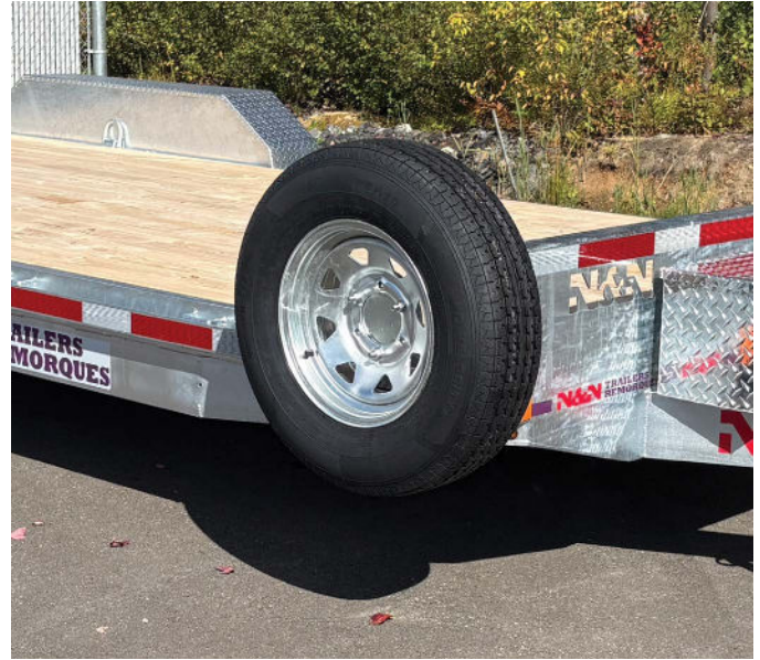
Support de roue de secours (boulonné)
