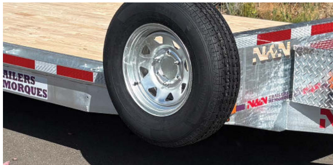
Support de roue de secours (boulonné)
