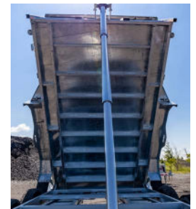
SÉRIE T Plancher en acier galvanisé de 7 ga | Traverses espacées de 12 po
