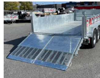
SÉRIE L (Landscape gate) Modèle 72 in : 8 500 lb | Modèle 82 po : 10 500 lb | Inclus essieux abaissés de 4 po | * Seulement disponible sur essieux de 7 000 lb
